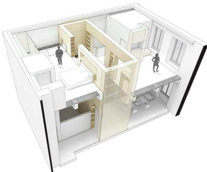
Qui sopra, spaccato assometrico del Loft a Firenze, ristrutturato da Fabbricanove e trasformato da ex sala da musica ad abitazione per famiglia. A destra, in primo piano, scala di acciaio inserita nel 'core' a doppia altezza, le cui pareti sono realizzate in legno e pagina accanto, il pavimento in vetro che si intravede fra un livello e l'altro.
